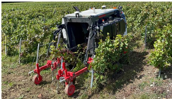
オペレータはシンプルなりモコンを介して「YV01」を遠隔監視でき、スプレーが届く範囲外から安全に、かつ転倒の危険もない状態から、「YV01」を監視できます。また、土壌耕作用として急傾斜地での機械的除草作業も可能となっており、除草剤の使用を抑制できます。さらに、「YV01」の輸送は小型トラックやトレーラーで簡単に行えます。これにより、オペレータはブドウ園での労働集約的な作業から解放されます。
