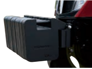
フロントウエイト30kg ウエイトブラケットKIT用ウエイトです。
