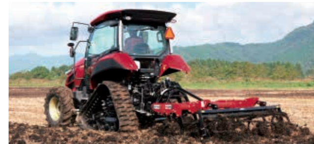
粗耕起作業: スピードカルチ (松山)
