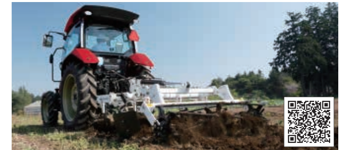
粗耕起作業: スタブルカルチ (スガノ農機)
