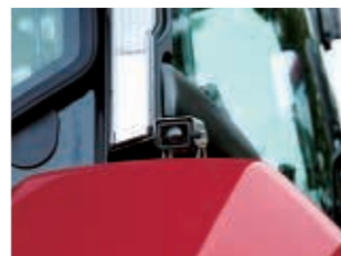
カメラKITリヤ 作業状態をモニターで確認できます。
