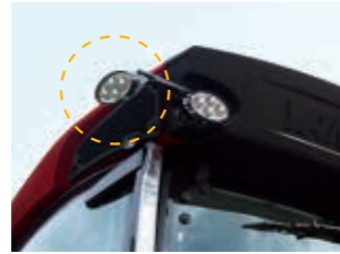
LEDリアワークランプ (ルーフ) 夜間作業時など横・後方の視認性を高めます。
