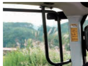
インブルモニターステー 作業機の操作BOX等を取付できます。
