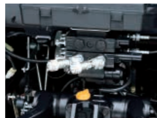
3/8クイックカブラ 油圧取出しがクイックカブラで付替え可能です。(3/8カブラ)
