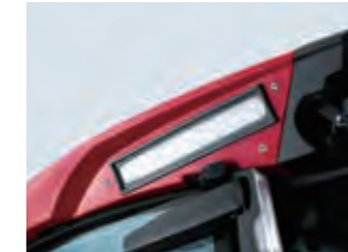
エアコン外気フィルタ 外気フィルタをキャビンルーフ左側面に設置しました。(キャビン仕様)
