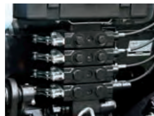
サブコン3~4連目KIT 油圧取出し3~4連目を追加できるKITです。
