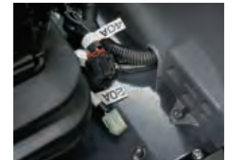
外部電源40A+20A シート右後ろに2つのコネクタを装備。大容量化する作業機の電源取り出しに対応します。
