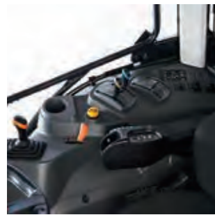
マニュアルシフト仕様 使いやすいようにシートの右側にスイッチ・レバー類を集中して配置しました。
