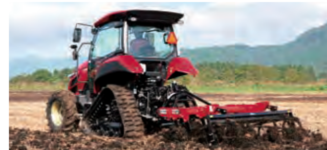
粗耕起作業: スピードカルチ(松山)
