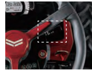
オートキャンセルウィンカ ハンドルを戻すとウィンカが自動的にキャンセルされます。
