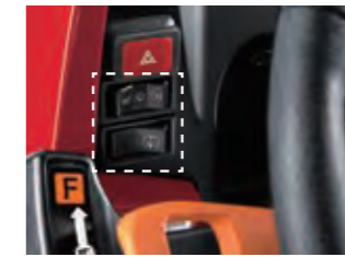
ワイパースイッチ フロントワイパーは間欠作動できます。(キャビン仕様)
