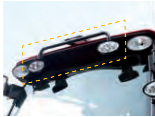
LEDフロントワークランプ (ルーフ) 夜間作業時など前方の視認性を高めます。
