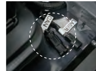
AG-PORTカブラ AG-PORT対応作業機に接続できます。また、エコトラリンク対応作業機と接続することで、トラクターとの統合制御が可能です。
