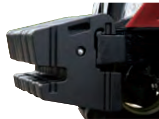
新フロントウエイト50kg ウエイト形状が前上がりになっており、あぜ際までの作業が可能になります。
