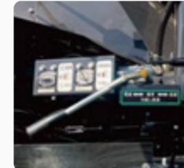
条件に応じて3段階に速度が切り替えられ、倒伏した稲も能率よく高精度に刈り取れます。
