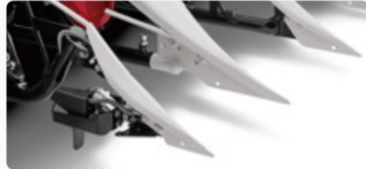
分草板に取り付けたソリセンサーがほ場の凹凸を感知して一定の高さで刈取りをおこなえます。※OKリフトへの切り替えもできます。
