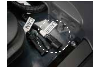
レーザーカブラ レーザー装置取付け時の送受信用。
