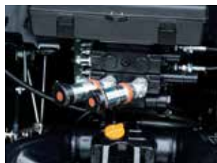
1/2クイックカブラ (ワンタッチ式) 油圧取出しがクイックカブラ (ワンタッチ) で付替え可能です。(1/2カブラ)
