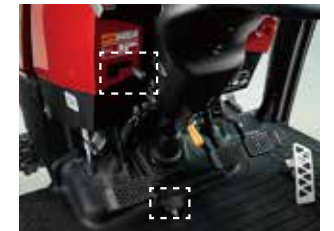
片ブレーキあしん機構 移動走行時の左右ブレーキペダル連結忘れを防止します。
