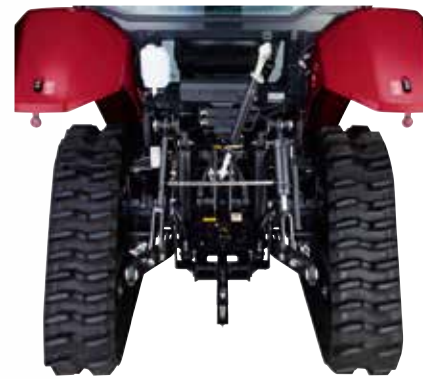
ナロークローラ仕様 クローラ幅280mmのナロークローラ仕様は、畑作管理作業に最適です。
