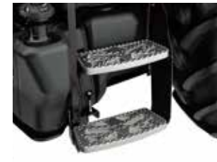
大型サブステップ (YT465Aデルタ、YT472A) 大型フェンダーと連結しており、泥飛び防止にも効果があります。
