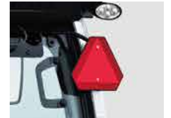
低速車マーク 夕暮れや夜間の追突事故を回避するために低速車マークを標準装備しています。
