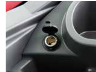
アクセサリソケット 外部電源の取り出しに利用できます。(シガーソケットとしては使用できません)
