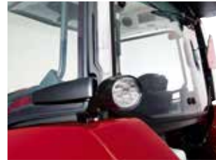
LEDリアワークランプ (フェンダー) 夜間作業時など後方の視認性を高めます。
