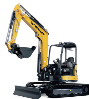
4柱キャノピー仕様 (ROPS※1/FOPS※2基準)
