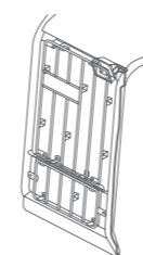
4柱キャノピー仕様 (ROPS※1/FOPS※2基準)
