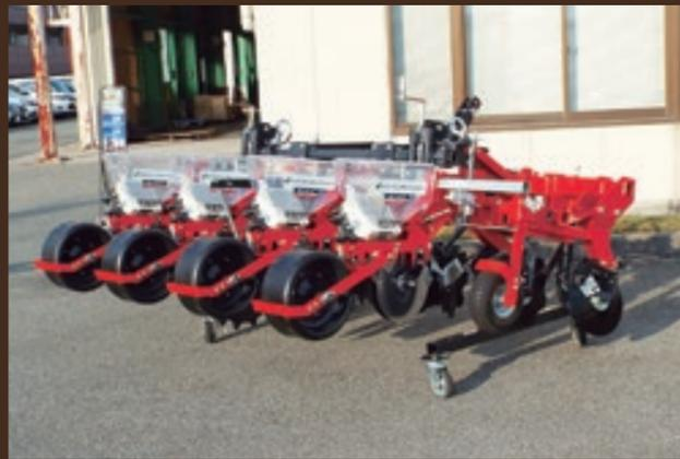
2024年春発売のトラクター用播種機HRP-4。うね立てと播種を同時に行い、水はけが良く発芽・生長しやすい環境を実現する大豆用の高速畝立播種機だ。
