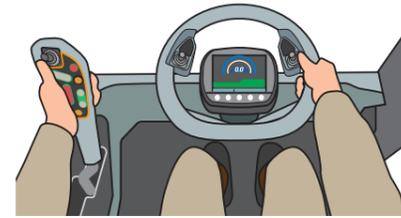
作業中の操作は、右手のハンドルと左手のレバーだけ。手と指先だけで自由自在な旋回や刈取部の操作ができ、高精度な作業と疲労軽減をサポートします。
