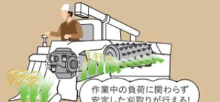
コンピュータ制御により作業中エンジンに負荷がかかると1/100秒単位で最適な燃料を噴射。エンジン回転数を落さず安定した作業を実現しました。
