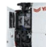
熱交換機表面へのチリの付着を低減し、長時間作業でもオーバーヒートを防ぎます。
