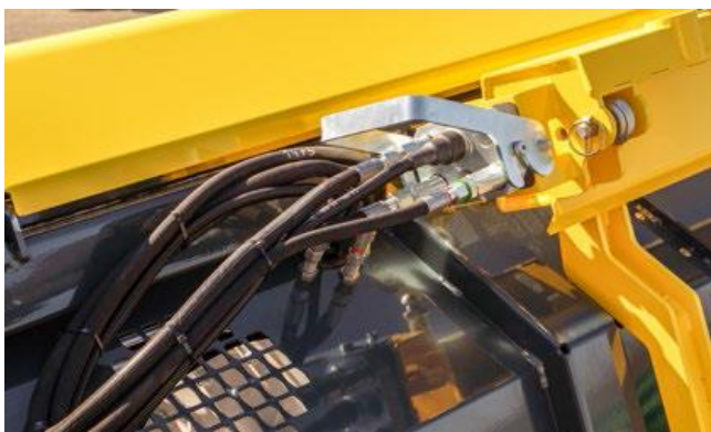
マルチカプラ(左)とオートカップリング(右)で簡単マッチング
