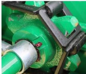
堆肥の搬送チェーンは平らな形であるため、チェーン同士のオーバーラップが大きくなっています。これにより、搬送時の力が分散され、チェーンの長寿命化を実現します！
