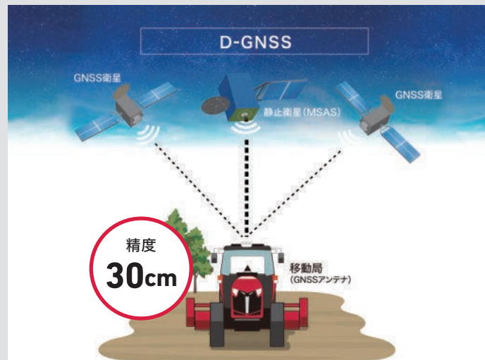
GNSS(GPS, GLONASS等) 衛星と静止衛星(MSAS) からの補正情報で位置を求める測位方式
