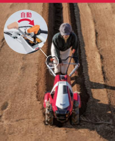
ハンドルを最下段に下げると、旋回レバーが「旋回」へ切り替わります。
