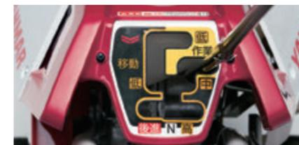
作業も移動もレバー1本。移動・後進時はロータリーが停止します。
