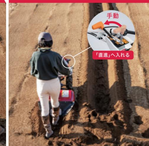
旋回後にハンドル高さを戻し、旋回レバーを「直進」に入れて、耕うん作業を再開します。
