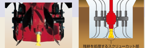
残耕を処理するスクリーカット部
