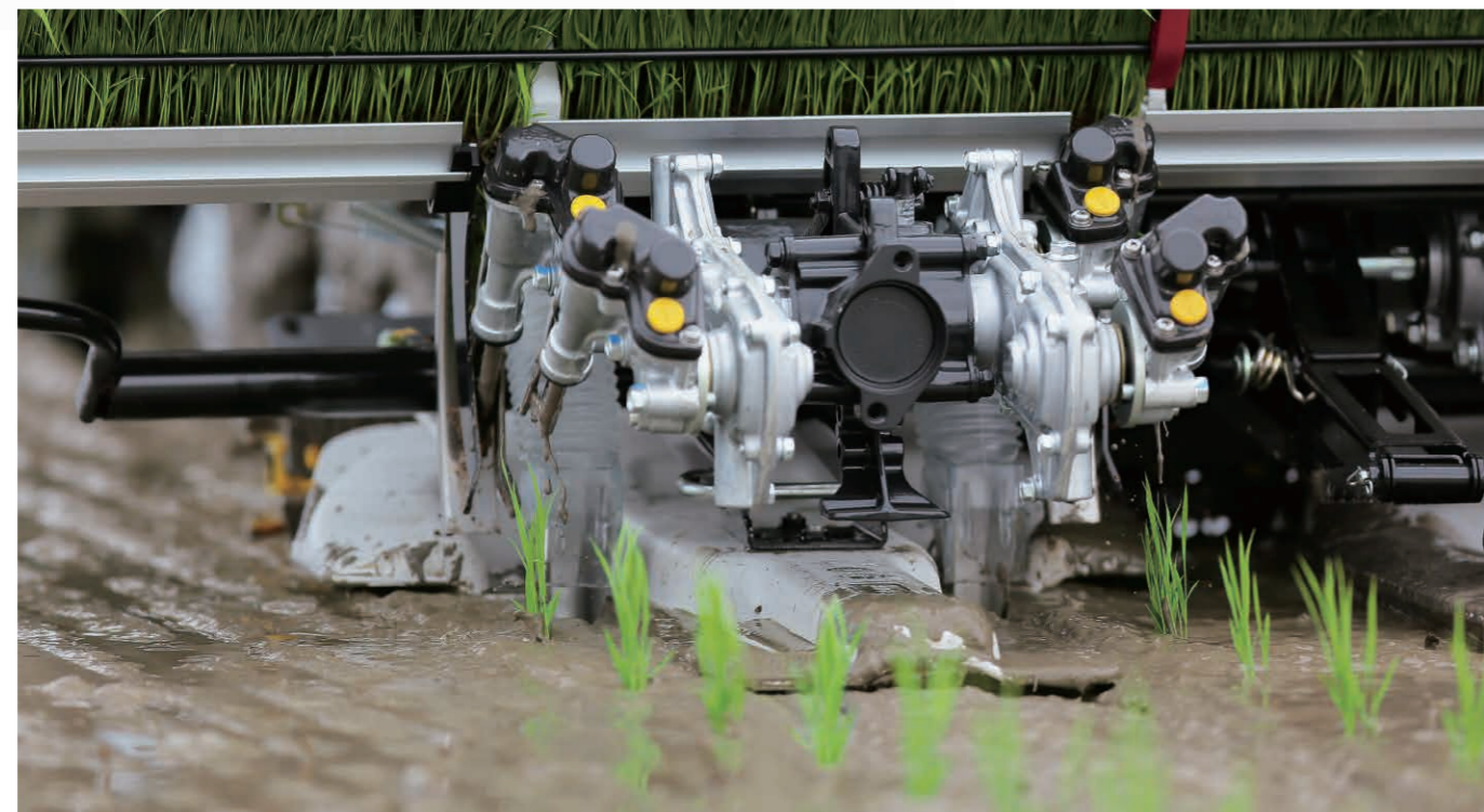
苗に接触しない、 植付けアームの オフセット配置。
