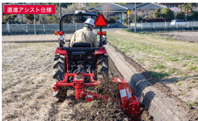
直進アシスト仕様 溝掘り作業 リターンテッジヤ〈松山(株)〉
