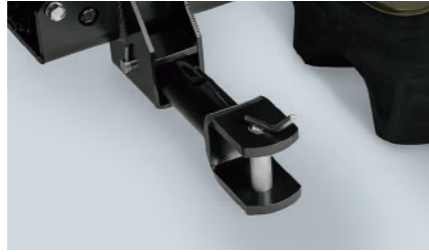
ドロバヒッチ トラレーザなどをけん引する場合に必要になります。
