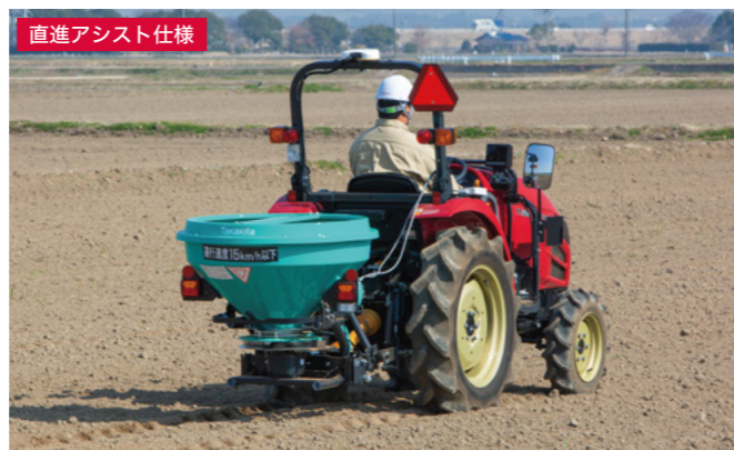
直進アシスト仕様 肥料散布作業 コンボキャスト〈(株)タカキタ〉
