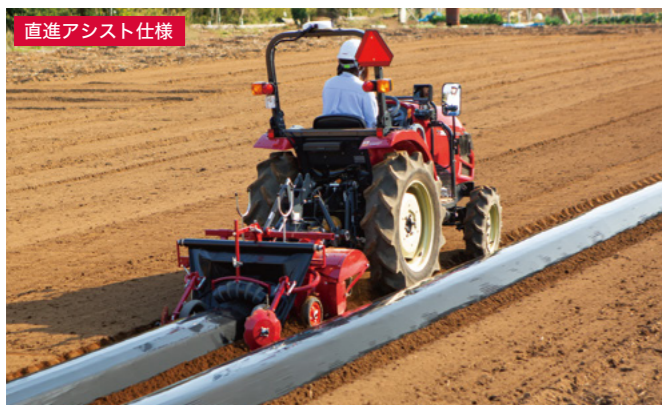
直進アシスト仕様 うね立て同時マルチ作業 うね立て整形ロータリ〈ヤンマーアグリ(株)〉
