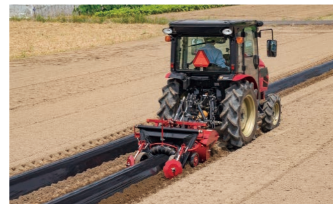
うね立て同時マルチ作業 うね立てマルチロータリ 〈ヤンマーアグリ(株)〉
