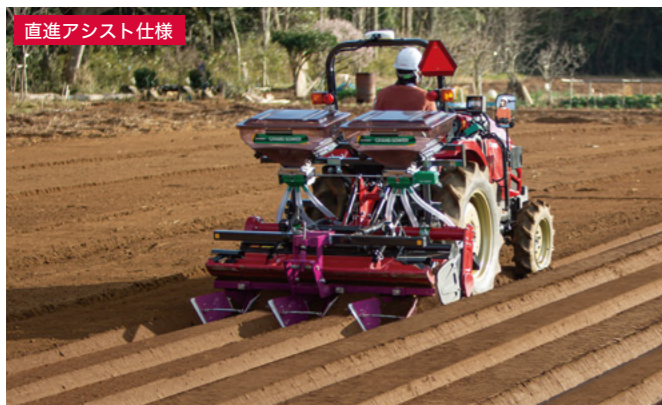
直進アシスト仕様 うね立て同時施肥作業 整形機〈(株)ササオカ〉 施肥機〈(株)タイショー〉
