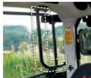
■ インプルモニターステー 作業機の操作BOX等を取付けできます。
