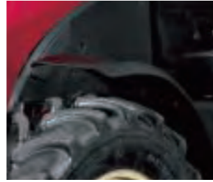
■ フロントフェンダー 移動走行の泥はねを防ぎます。
