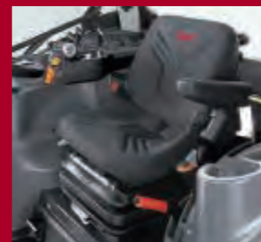
■ メカサスシート (YT488R) 振動を吸収するサスペンションシート。
