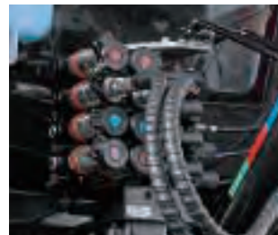
■ サブコン4連目KIT 油圧取り出し4連目を追加できるKIT。 ※3連目は油圧トップリンクで使用。
