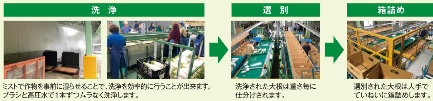
ミストで作物を事前に湿らせることで、洗浄を効率的に行うことが出来ます。ブラシと高圧水で1本ずつムラなく洗浄します。
