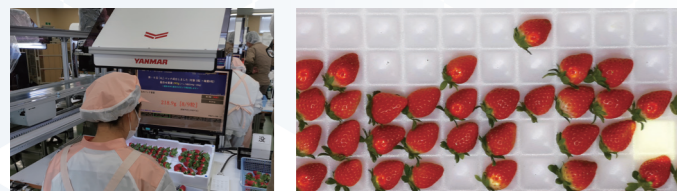
パック詰アシスト装置 プロジェクションマッピングの様子
