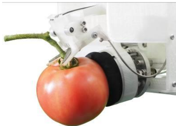
<左:認識カメラによる形状解析、右:独自開発の「吸着切断ハンド」>
