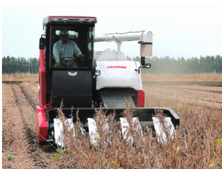
YH700M 用 4畦ロークロップヘッダー ユニット：CRC4A,700M プラットフォーム：CRC700M,PF
