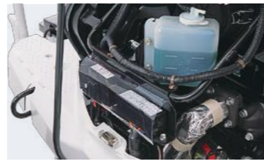
■ ヒューズBOX・クーラント ヒューズや冷却水の点検が簡単。
