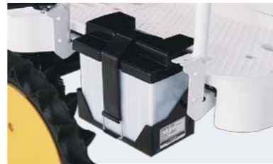
■ バッテリー 交換しやすい右予備苗台下部に配置。
