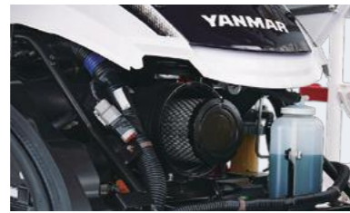
■ エアクリーナーエレメント 簡単に取り外せ掃除・交換も容易。
