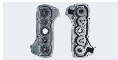
■ ロータケース ギヤの軸受部にベアリングを使用。
