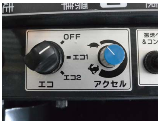
<エンジン回転数をセットする「エコモードスイッチ」イメージ>
