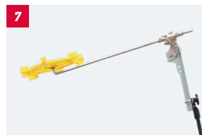
7 風車マーカ 土を盛り上げて跡をつくるので直進の目安がよく見えます。
