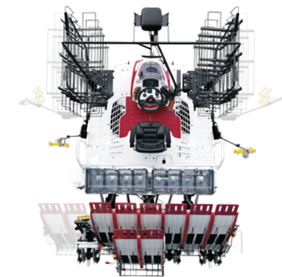
5 折りたたみ式苗のせ台 2条分がたたためて、移動や収納が容易。
