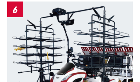
6 回転式32枚予備苗のせ代 苗の補給回数が減り、回転式なのでラクに苗補給ができます。
