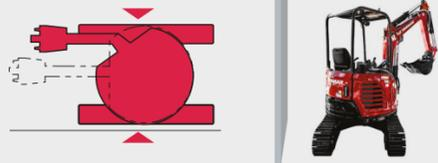
Escavação lateral de valas bem próxima à parede sem sair do alinhamento.
