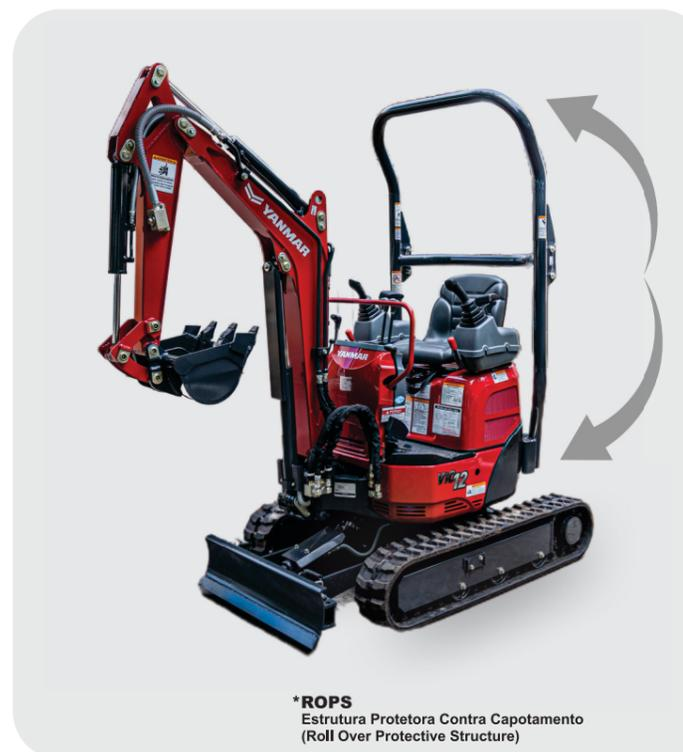
\*ROPS Estrutura Protetora Contra Capotamento (Roll Over Protective Structure)
