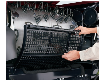
8 高張力鋼板受け網脱着
