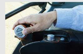
手で軽く操作するだけで、無段階に変速できます。右ひじをかけたまま操作でき、疲れにくい。
