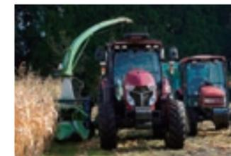
しかし、ロボトラ®なら自動で刈取りをしてくれるので、1人のオペレーターがそれを監視しながら細断型ロールベアラで作業することが可能。つまり、1人で2つの作業を同時にこなすことができ、2人必要だった作業が1人でできるようになりました。
