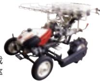
●2条千鳥状の直立植えで、高い栽植密度と手作業の約3倍の能率を実現する、「平床挿し苗栽培」対応の慣行ねぎ苗移植機です。
