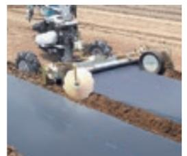
●管理機へは、けん引用ヒッチにマルチのピッチをヒッチピンで取付け押しボルトで固定します。
