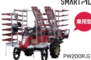
セル成型苗をトレイにセットするだけの全自動タイプ。植付速度0.52m/秒とスピーディな植付けで、移植作業を大幅に省力化できます。
