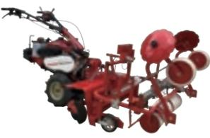
●うね立て・播種・有孔フィルム被覆・覆土・鎮圧作業が1行程で行えます。
