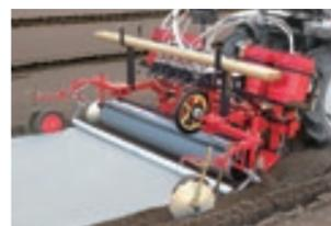
●「マルチング」、「全面鎮圧」の作業が1台で可能。しかも、露地やハウス、各薬剤別(クロルピクリン・D-D)にも対応できる、高性能な土壤消毒機です。
