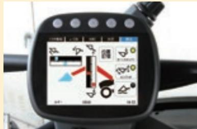
トラクターのカラーモニターで設定や作業状態を確認できる!
