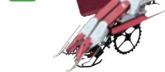
● 茎搬送部がスイングするため、引抜いた茎・葉を左右のバケットに振り分けられます。
