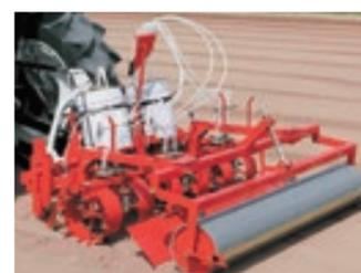
●接地輪駆動により、作業速度に連動した薬液注入が可能です。薬液注入、鎮圧した跡を均一にしながら全面鎮圧することによってガス抜けを防止し、薬剤効果を発揮します。
