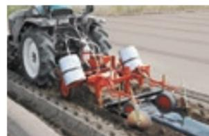
●上段15cm、下段30cmの2段注入により浅・深層部の線虫・病原菌に薬剤効果を発揮します。
