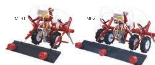
●ポンプは接地輪駆動(大型タイヤ採用)方式なので、作業速度に関係なく、ムラのない一定量の注入が行えます。また、検流計により、トラクターの運転席から吐出の確認が容易に行えます。
