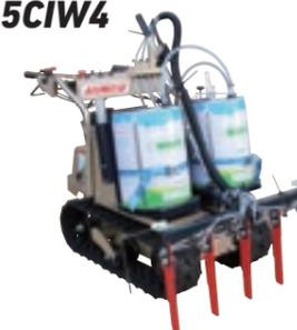
●従来の土壤消毒機(点注式)とは異なり、薬液を連続して線状に吐出する連続注入式を採用。20cm間隔で注入刃の上下2か所から吐出(2段注入)するため、より均一に土壤消毒ができます。
