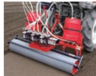
●モーター駆動ポンプで、強制吐出させながら注入ができるため、薬剤の注入抜けがありません。また、駆動ポンプの採用で注入ピッチを短くすることが可能となり、病原菌の多いほ場での応用がききます。
