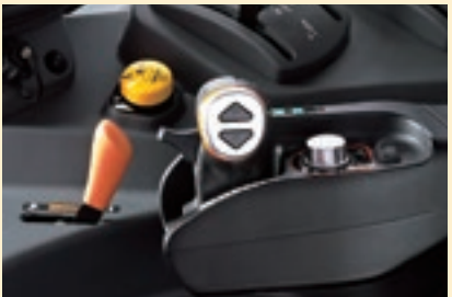
トラクターの操作レバー・スイッチで作業機が操作できる!
