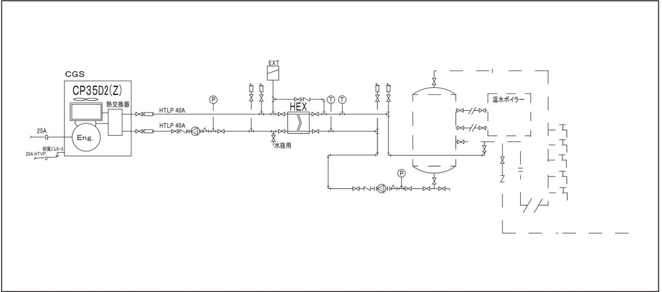
**CP35D2(Z) (標準機/停電対応機)×3台 温水配管系統図(例)**
