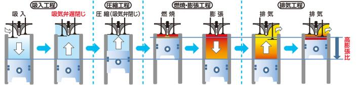
ミラーサイクル化によりポンピングロスを低減し、高膨張比化することによりエンジンの熱効率が向上します。
