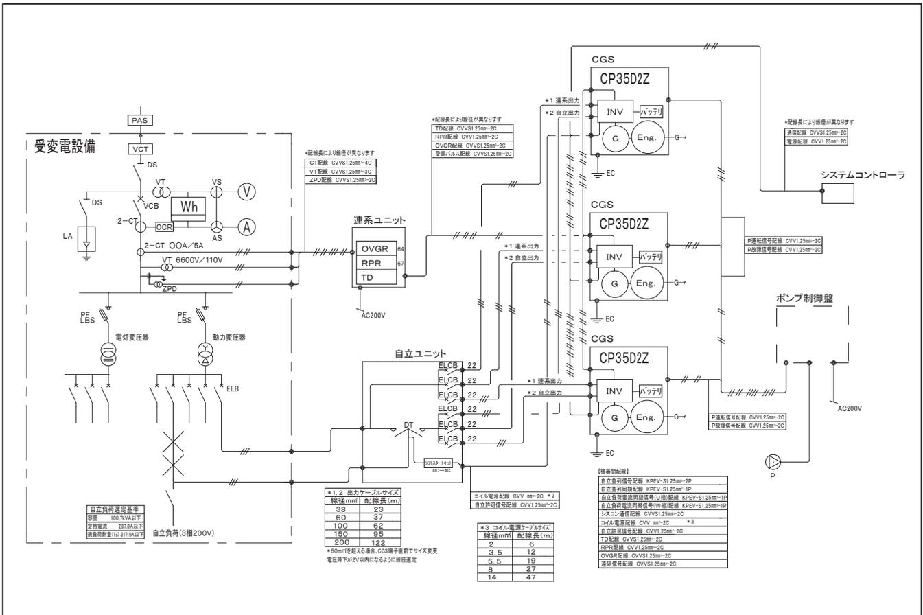
**CP35D2(Z) (標準機/停電対応機)×1台 温水配管系統図(例)**
