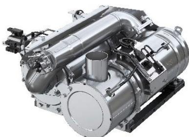
排出ガス後処理ユニットは、TNV コモンレールシリーズで培ってきた、市場評価の高い独自の DPF 再生制御を採用するとともに、ミキサー<sup>※7</sup>レスの SCR システムを採用しており、ミキサー不要による排気背圧の低減により、作業機における排気尾管設計の自由度が向上します。また、コンパクトな設計により様々な作業機への優れた搭載性を実現し、特殊工具が不要な構造設計によりメンテナンス時間の低減に貢献します。
