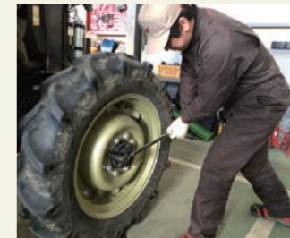
ゆるんでいる場合は、トルクレンチを使い、増し締めします。
