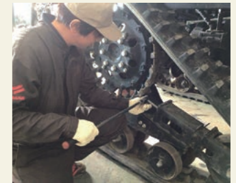
長期格納するときは、クローラの張りをゆるめておくと、クローラが長持ちします。
