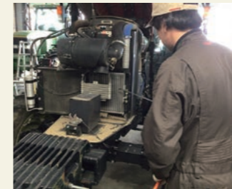
エアブローなどを利用して、ホコリやゴミを吹き飛ばします。
