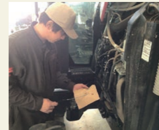
検油ゲージでオイル量を点検し、不足していれば規定量を補給します。
