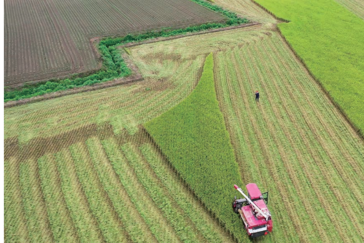
コンバイン(YH6115)には刈高さの自動制御が搭載されており、機械の操作も快適にできると喜ばれている。
