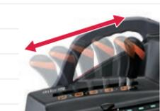
J-change Plusにより、クラッチ操作なしで主変速レバーによる10段の変速が可能です。(X仕様)
