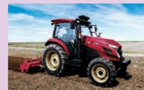
作業も旋回も自動。オペレータは緊急時のブレーキ操作だけでOKです。
