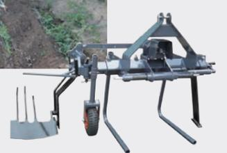
グレードアップした、専用ネギ掘取機!
