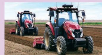
トラクターに乗車することなく、近距離監視のもとタブレットひとつで作業をコントロールできます。
