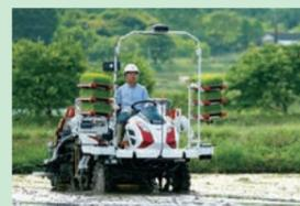
直進アシスト田植機は、まっすぐ自動直進でハンドル操作いらず。さらに苗量・施肥量も設定通りに作業でき、作業精度がアップします。オート田植機は旋回も自動で行えます。
