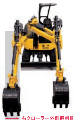
右クローラー外側掘削幅
