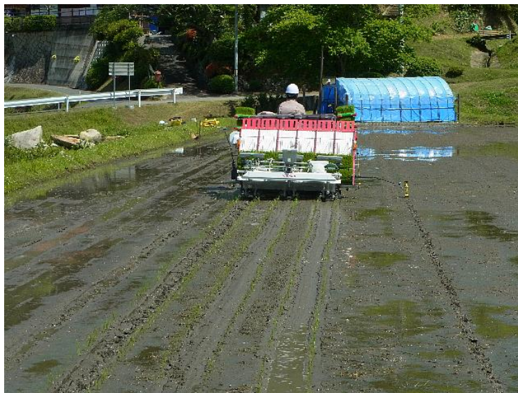
写真5 密苗対応田植機による移植風景。
